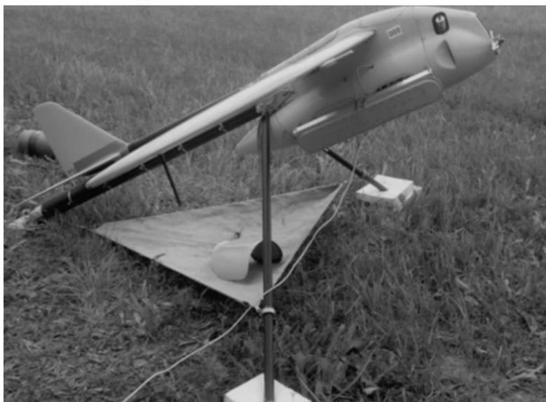
Рис. 18. БЛА «Мерлин-21Б» с РСА С-диапазона
