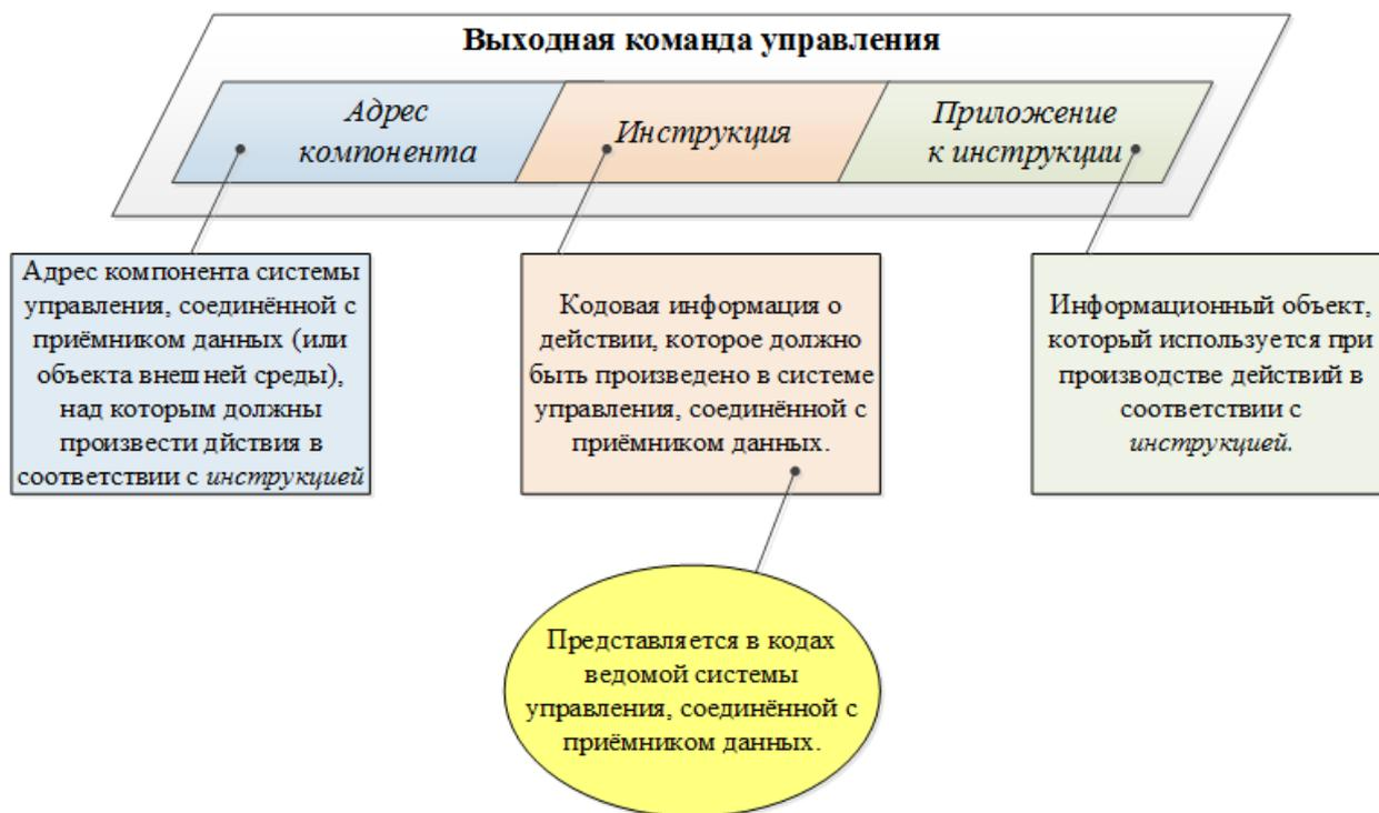
Рис. 4. Структура выходной команды управления
