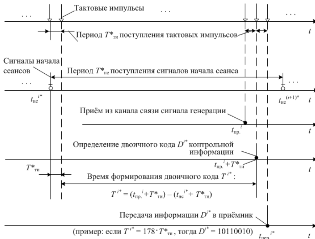
Рис. 4. Временные диаграммы обработки информации в приёмном пункте (пример)
