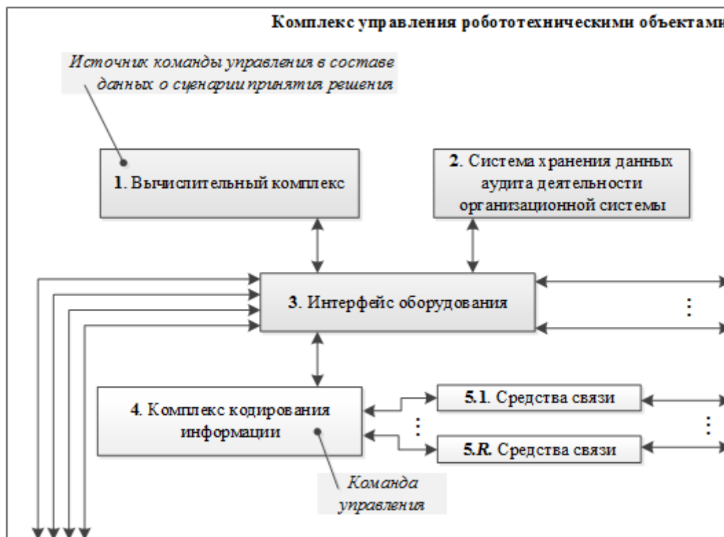
Рис. 1. Структурная схема комплекса управления робототехническими объектами
