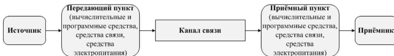
Рис. 5. Тракт передачи информации (пример)
