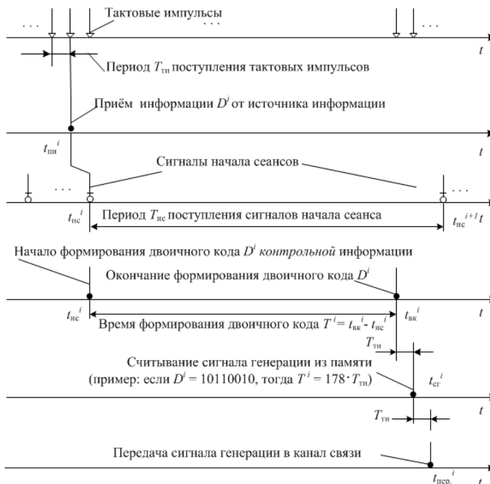
Рис. 3. Временные диаграммы обработки информации в передающем пункте (пример)
