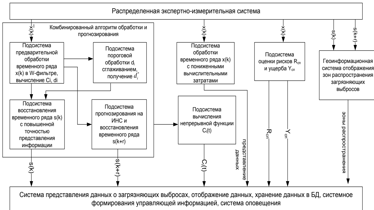
Рис. 10. Структурная схема программно-аппаратной части автоматизированной системы мониторинга
